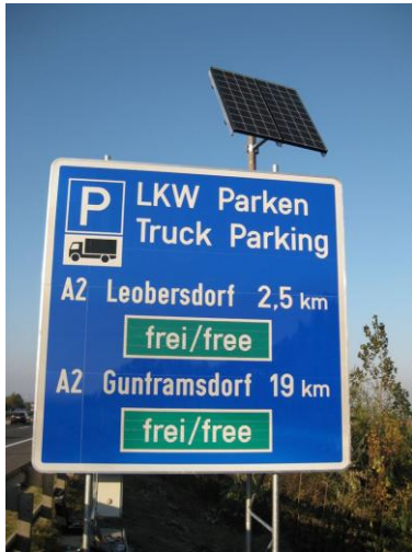
Abb. 6.19 Hinweis über Lastwagenabstellplätze mit Dynamischer Anzeige über die Belegung (Frei/Besetzt)
